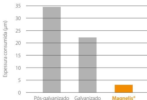
Resultados de um ensaio de corrosão cíclica 3CT (VDA 621-415). Fonte: ArcelorMittal Global R&D.
