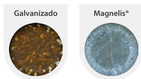
Após 1 440 horas de ensaio de névoa salina sobre uma copa Magnelis®, não se observou o aparecimento de ferrugem, enquanto que a copa galvanizada aparece completamente corroida.
