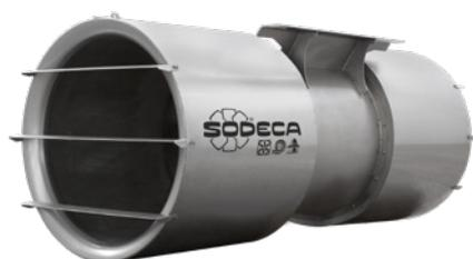
Jet fan unidirezionale, di grande robustezza ed elica in fusione di alluminio per spinta media. Disegnati specialmente per la ventilazione di gallerie e per l'evacuazione di fumo in caso d'incendio, certificati 400 °C/2h e 300 °C/2h a seconda del modello.
